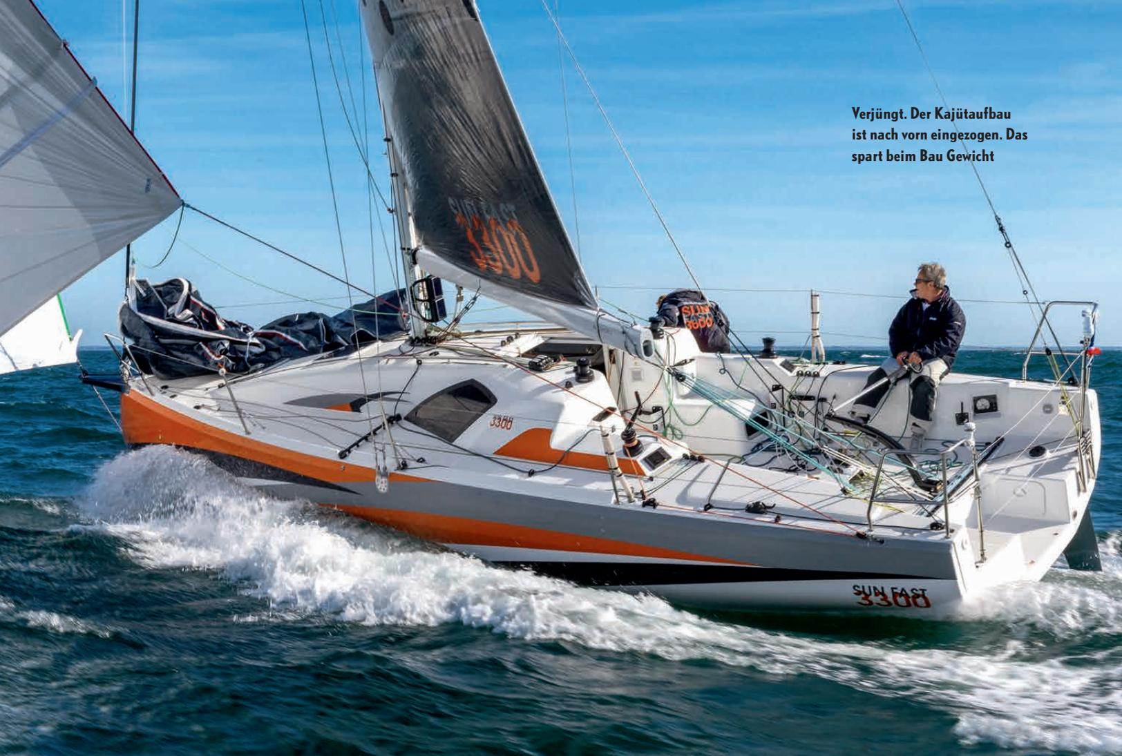
**Verjüngt. Der Kajütaufbau ist nach vorn eingezogen. Das spart beim Bau Gewicht**
